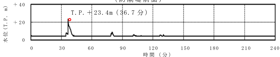
【取水口前面において最高水位をもたらす敷地に遡上する津波の時刻歴波形】 (防潮堤前面)
