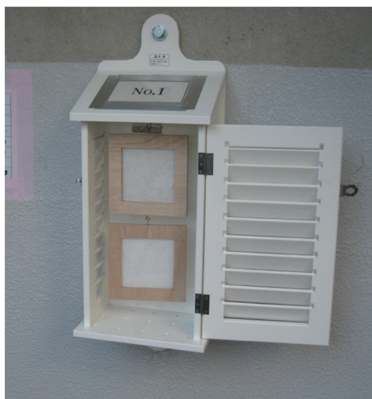
図 4. 1. 4-2 飛来塩分捕集器 (ドライガーゼ法)
