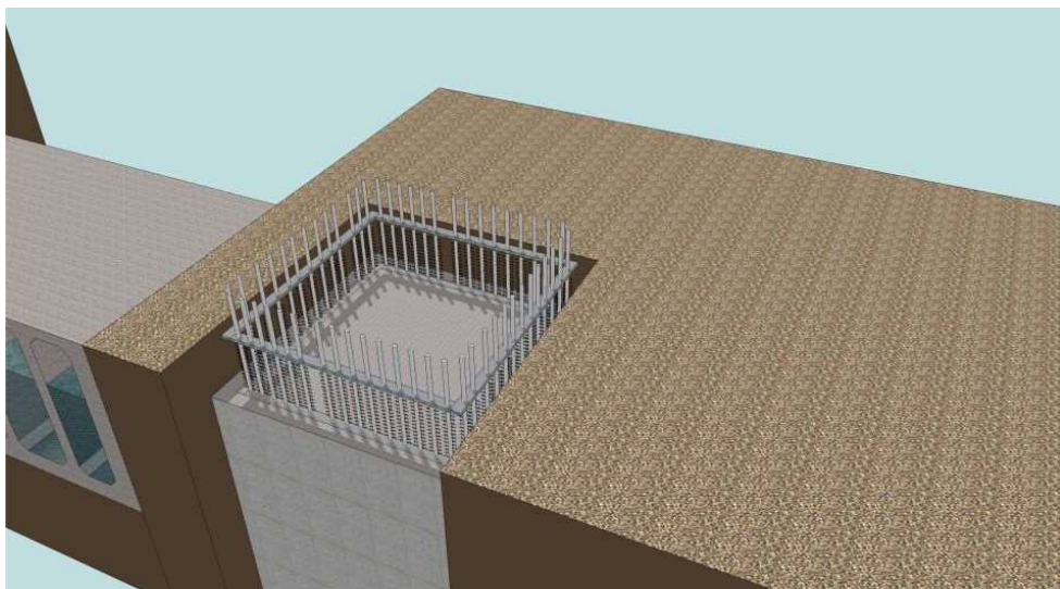
第 4-1 図 Step. 1 アンカーボルトの設置
