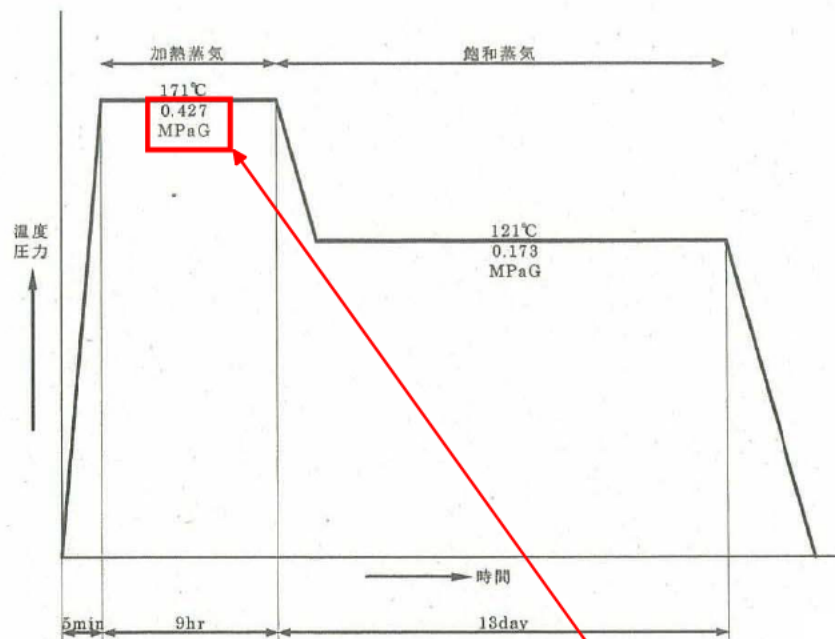
図 1.2.3-2 蒸気暴露試験条件-1 (BWR プラントの LOCA 時の原子炉格納容器内の雰囲気気を包絡)
