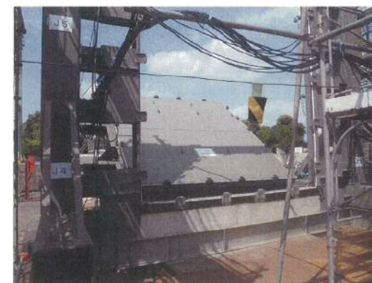
実機大ブローアウトパネル開放試験のイメージ (2012年 自主的安全性向上の一環として、原子炉建屋6階北側強制開放装置設置時の試験例)
