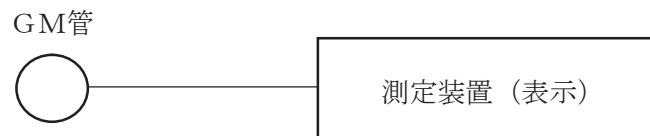
図 3.4-3 \beta 線サーベイ・メータの概略構成図
