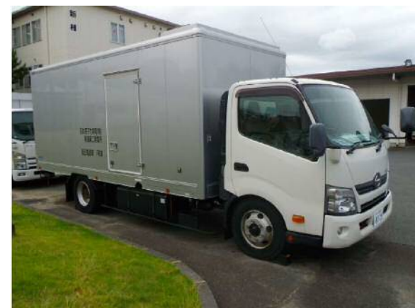
可搬型代替交流電源設備
