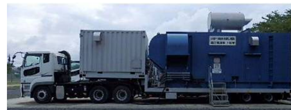
常設代替交流電源設備
