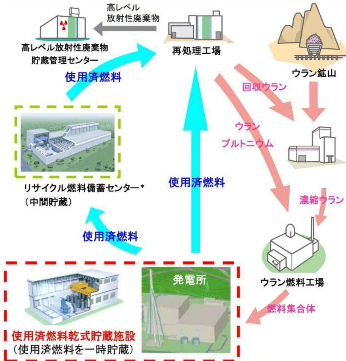
核燃料サイクルと使用済燃料乾式貯蔵施設の関係の概念図
