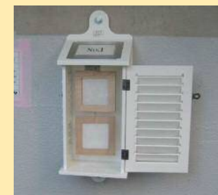
飛来塩分捕集器 (ドライガーゼ法)
