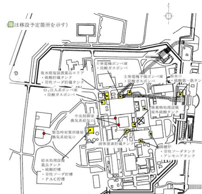
屋外設備の貯蔵箇所
