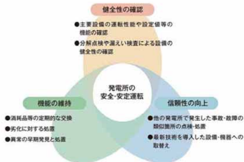
原子力発電所の定期検査の目的
