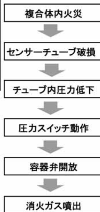
消火設備動作フロー図 (自動消火の流れ(電源不要))
