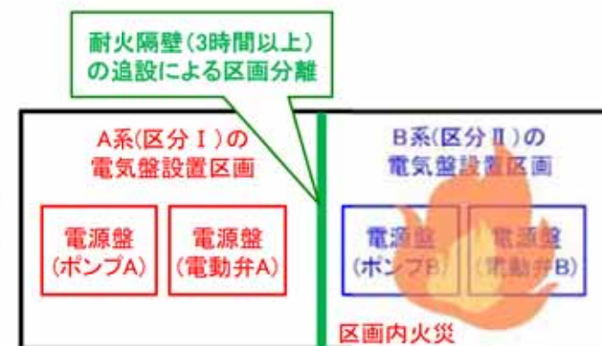
電源盤の系統分離イメージ(例)
