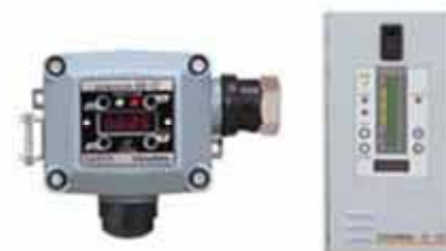
水素検知器の設置（蓄電池室等）
