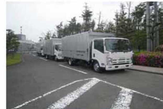
可搬型代替低圧電源車
