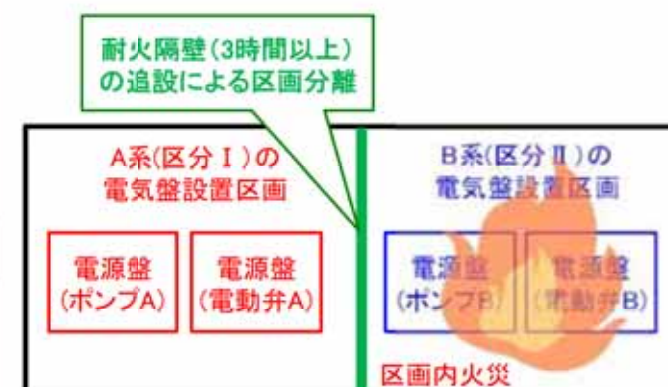
電源盤の系統分離イメージ(例)
