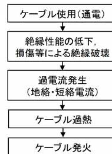
【絶縁性能の低下によるケーブル発火メカニズム】
