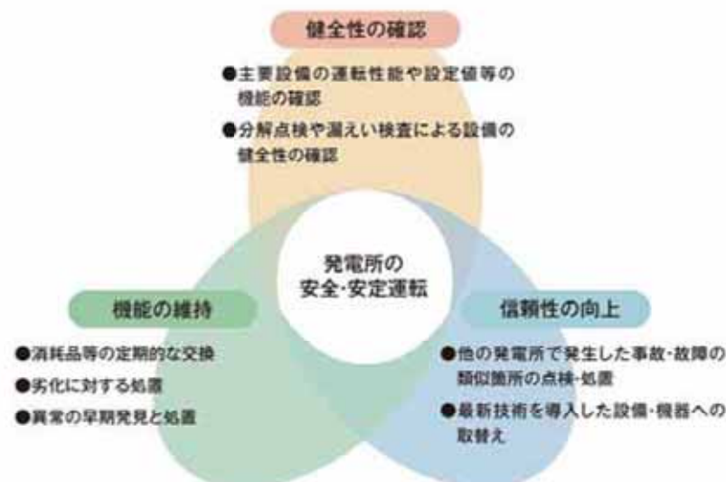
原子力発電所の定期検査の目的
