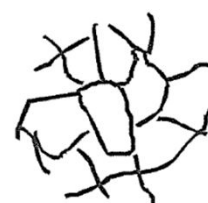
① 表面ひび割れ
