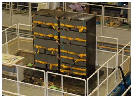
可搬型設備の加振試験
