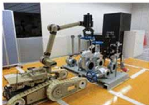
バルブの開閉操作
