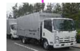
窒素供給装置用電源車
