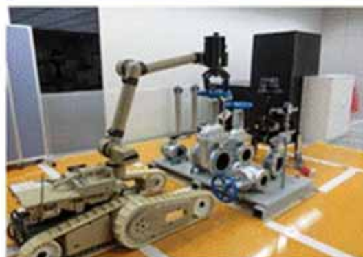
バルブの開閉操作
