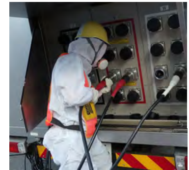
（実機による訓練）可搬型代替低圧電源車の設置・運用
