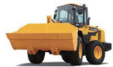
瓦礫撤去用重機 (ホイールローダー)
