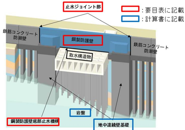
図 2-3 鋼製防護壁の構造概要図
