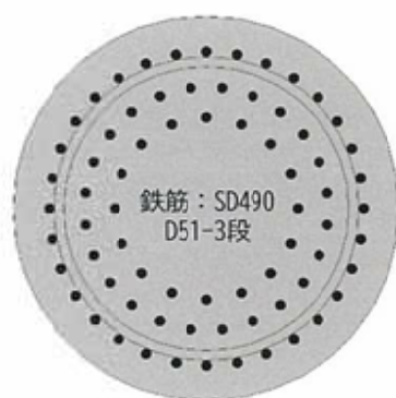
図-1 仮想RC断面 (鋼管杭)
