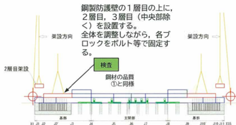
鋼製防護壁架設手順（イメージ：その1）
