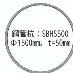
鋼管杭の構造仕様
