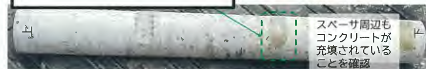
試験体の切断観察結果
