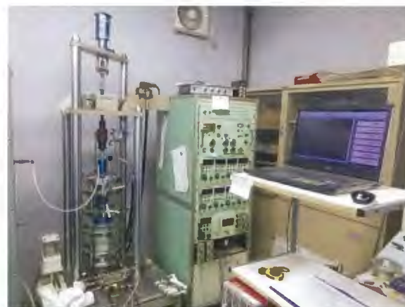
中空繰返しねじり せん断試験状況
