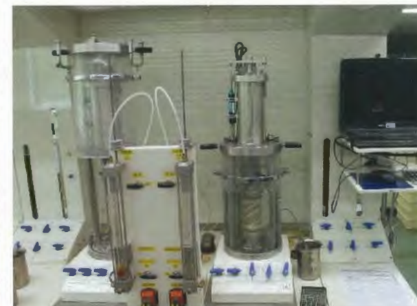
繰返し非排水三軸試験状況
