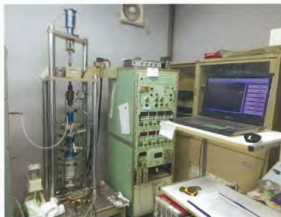
中空繰返しねじりせん断試験状況
