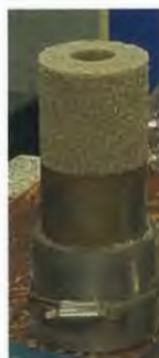
中空繰返しねじりせん断試験用供試体 作成装置及び供試体成型状況
