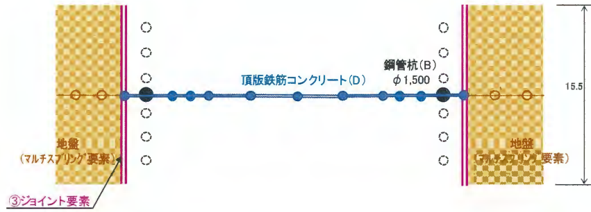
頂版鉄筋コンクリート (A-A)
