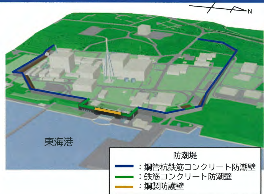
東海第二発電所 防潮堤設置計画図
