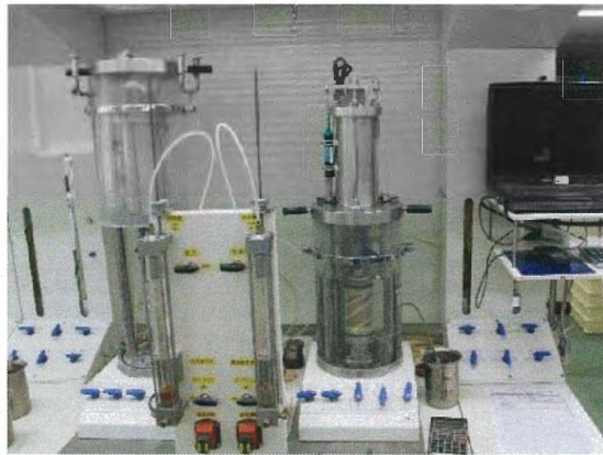
写真 3.6-10 繰返し非排水三軸試験状況
