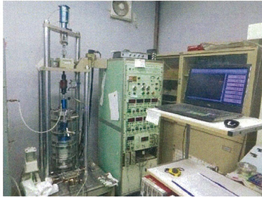
写真 3.6-9 中空繰返しねじりせん断試験状況
