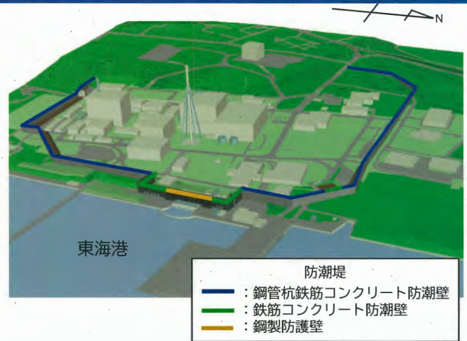
東海第二発電所 防潮堤設置計画図
