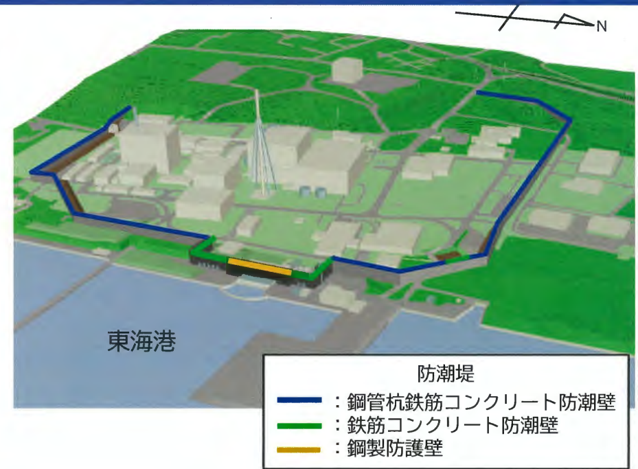
東海第二発電所 防潮堤設置計画図
