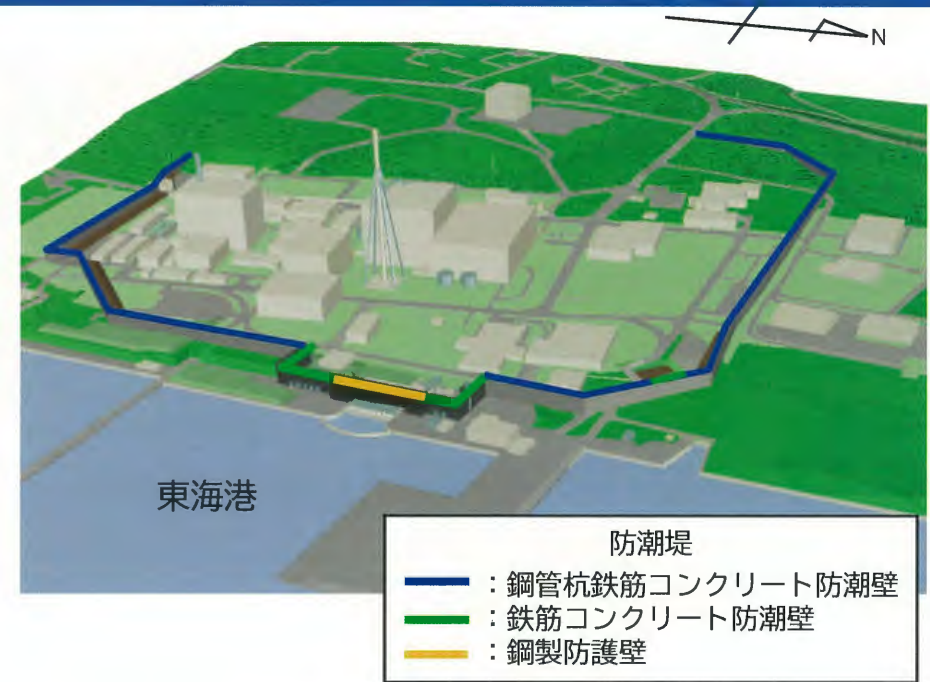
東海第二発電所 防潮堤設置計画図
