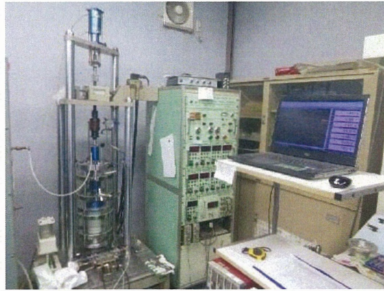
図 3.6-67 中空繰返しねじりせん断試験状況
