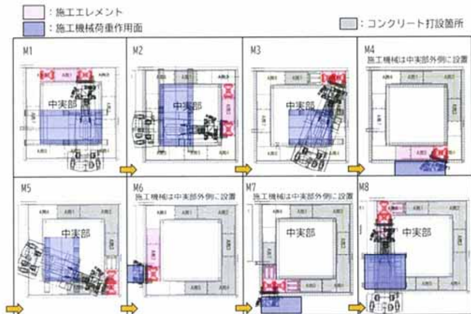
図 5.3-12 各ステップの施工機械の位置（施工機械荷重の履歴）
