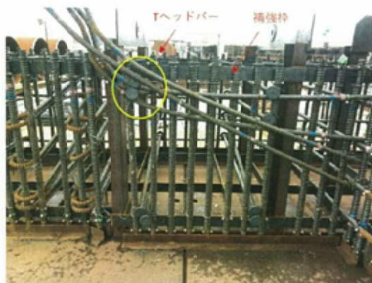
モックアップ試験 (水平鉄筋の変形状況)
