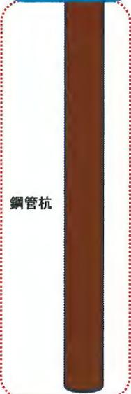
鋼管杭及び巻立て鉄筋コンクリートに対しては、特に浅部における応力集中が顕著であり、本発生断面力（曲げモーメント）に対応するため、巻立て鉄筋コンクリートに高強度鉄筋SD685を採用している。杭頭接合部においても同様の設計状況となる。
