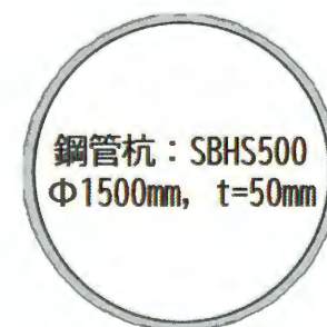
鋼管杭の構造仕様
