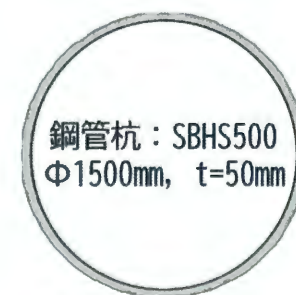
鋼管杭の構造仕様
