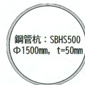
鋼管杭の構造仕様
