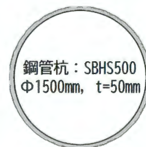
鋼管杭の構造仕様
