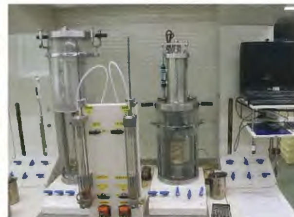
繰返し非排水三軸試験状況
