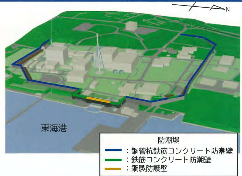
東海第二発電所 防潮堤設置計画図
