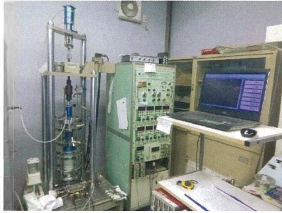
図 3.6-67 中空繰返しねじりせん断試験状況
