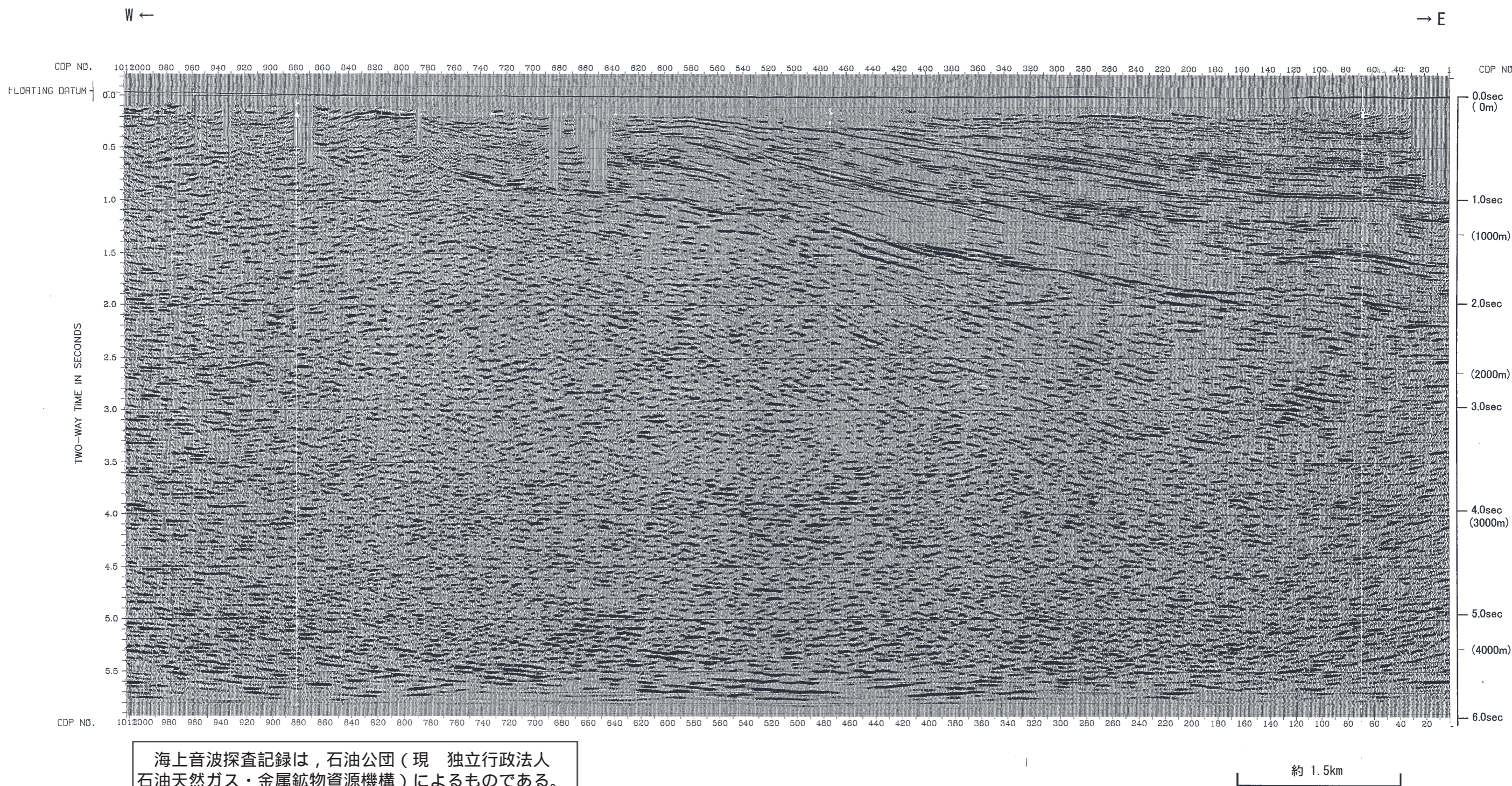
第6.3.2-141図（1） 陸域から連続する地質断面図と対比した海上音波探査記録（SN94-2）
