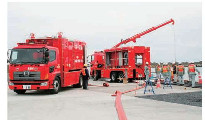
大容量ポンプ車による海水送水訓練
