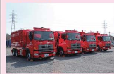
大容量ポンプ車とホース延長車
