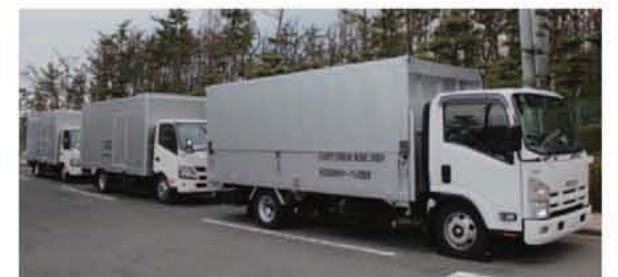
移動式低圧電源車と専用電源ケーブル搭載車
