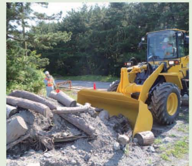
発電所内の道路にがれきなどが散乱してアクセスできなくなった場合を想定したホイールローダによる障害物撤去訓練
