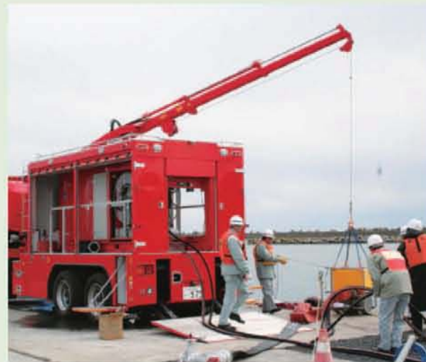
大容量ポンプ車を使用した送水ポンプの海中投入・送水訓練
