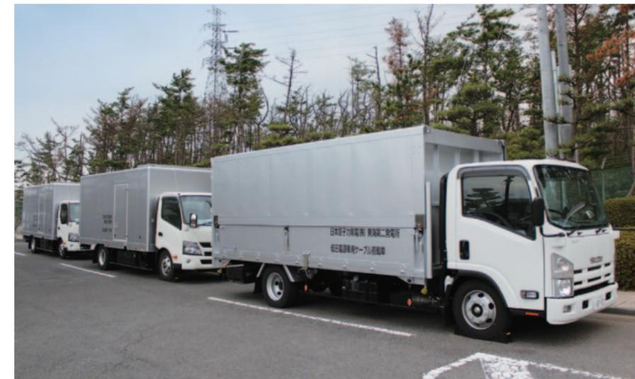
低圧電源車(2台)と専用電源ケーブル搭載車(1台)
