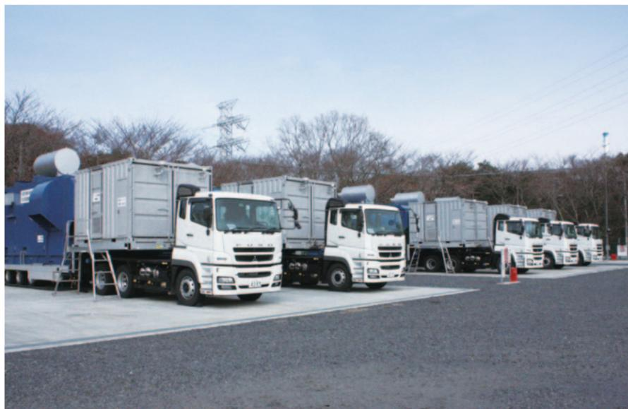
空冷式の大容量高圧電源車(5台)
