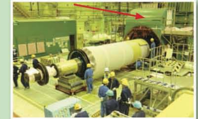
④ 発電機固定子(巻線の巻き替え)
