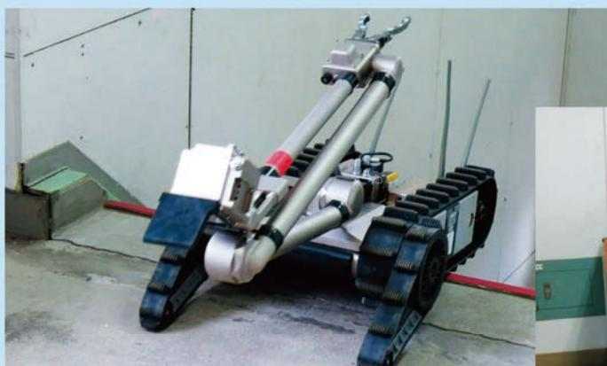
災害現場を探索するために階段を登る災害対策用ロボットの
