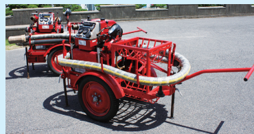
可搬式ポンプ
