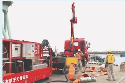
①ディーゼル発電機の運転に必要な冷却用の海水を汲み上げるため、大容量ポンプ車を水源近くに配備
