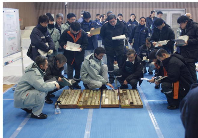
敷地及びその近傍にて採取したボーリングコア（地層から抜き取った円筒形の試料）を確認
