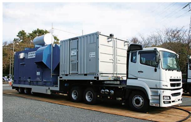
非常用電源車
